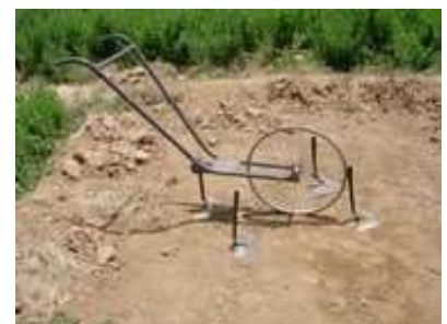
Fig. 3. Sarcleuse de Lara, construite au Sénégal suite à l'envoi des plans par email
